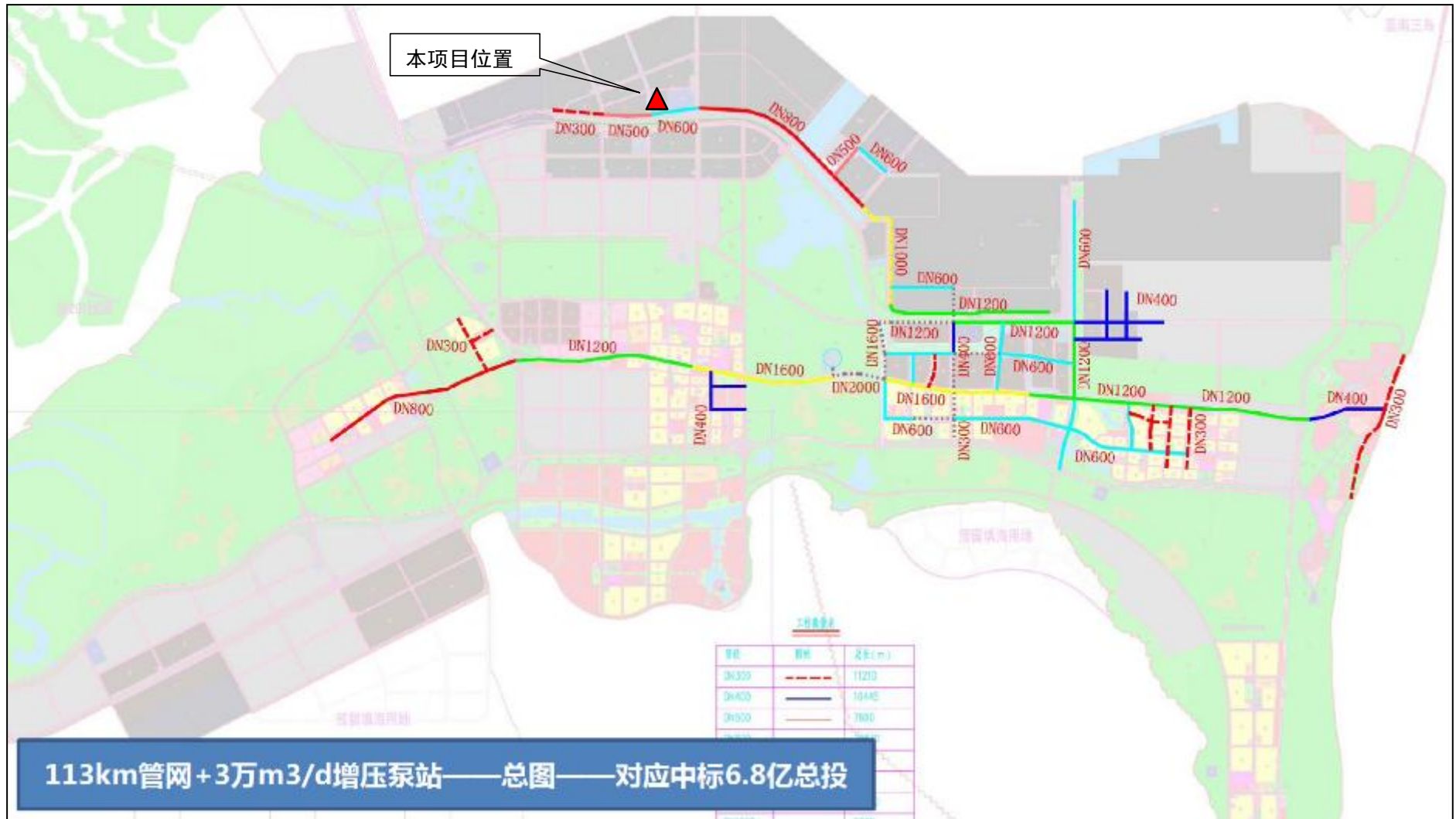
图 2.4-3 东海岛自来水厂一期配套供水管网工程管道布设示意图
